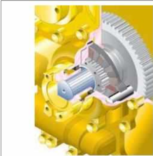
Resim 4.1: Cer dişlileri disk pleyt grubu
