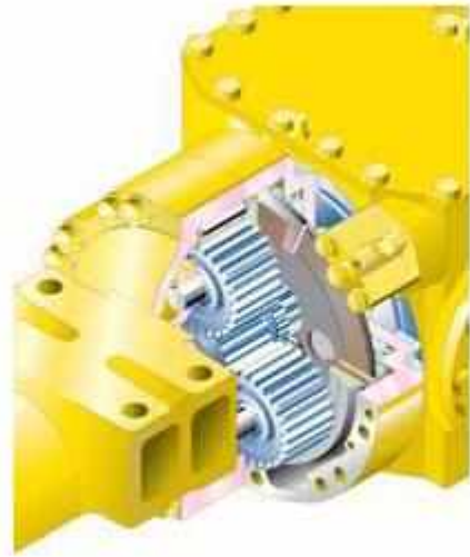
Resim 4.2: Diferansiyel disk pleyt grubu
