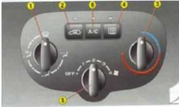
Havalandırma /ısıtma kumanda paneli
