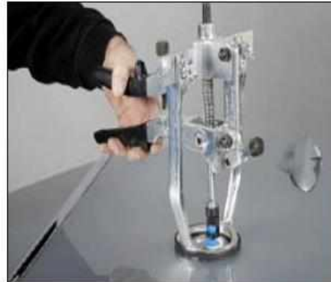
Resim 1.7: Yapıştırma pabuçları ile düzeltme
